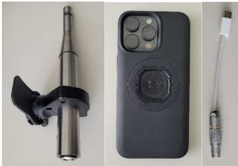
Abbildung 2.2: Produktkomponenten: Mikrofon in Halterung, iPhone in Schutzhülle, kurzes Verbindungskabel.
