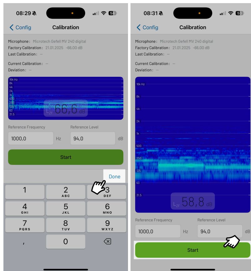
(a) Frequenz und Pegel des Kalibrators eingeben.
