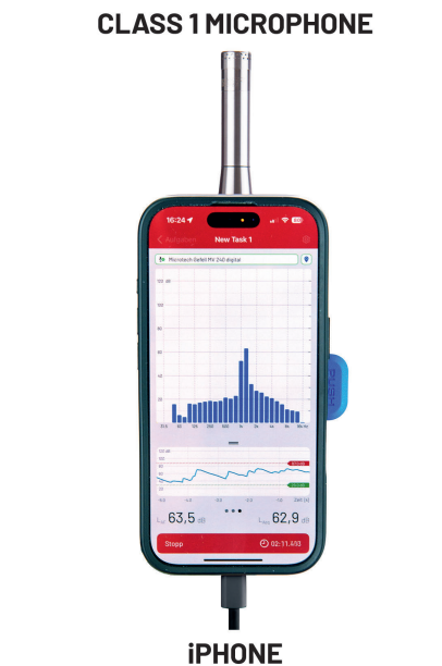
Das Basis-Set-up: ein iPhone mit installierter „acoust IQ“-App sowie ein Klasse-1-Mikrofon. Grafik: Müller-BBM
